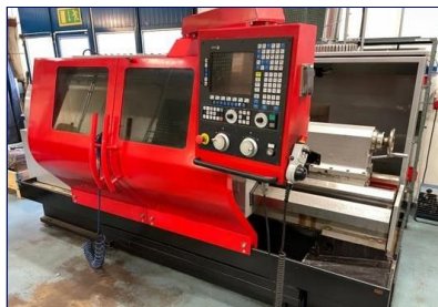
Torno cilíndrico CNC 1500x300 mm EMCO Emco MAT300 Ref: CEM-025
